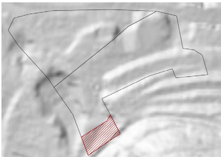
Slika 32: Del zemljišča v bližini zaledne brežine, kjer je za izvedbo posegov potrebno predvideti stabilizacijo zaledne brežine.
